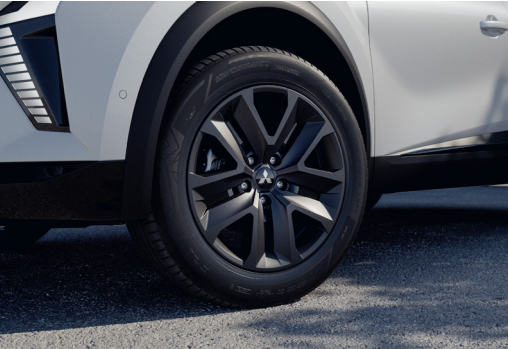
▲ Jante de aço 17" Roda MQ001588 Tampão cinzento Gun metal MQ001608G Tamanho de pneu recomendado: 215/60 R17
